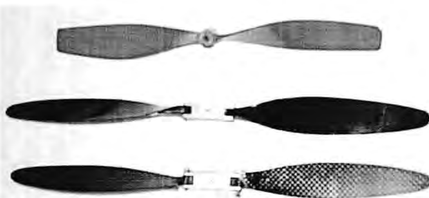
Fig.3.6 – Eliche utilizzate nello studio. Dall'alto verso il basso, sono : Modela ,FSK e FSK modificata
