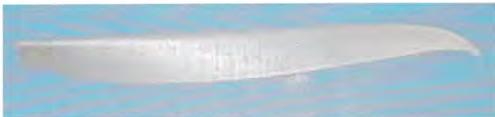
Fotografia della pala costruita con tecnica steleolitografica
