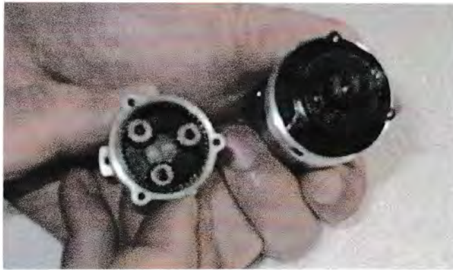
Vista dei particolari interni di un riduttore epicicloidale
