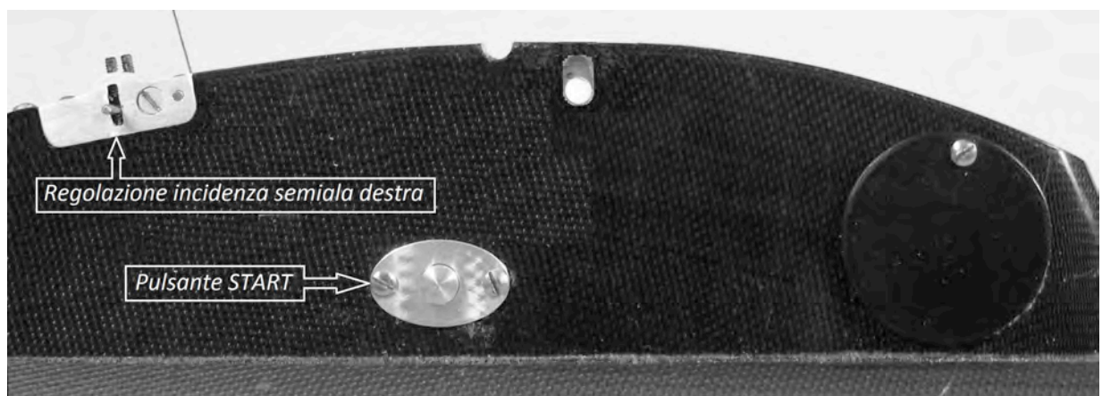
2 - Dettaglio: la nuova regolazione della semiala destra
