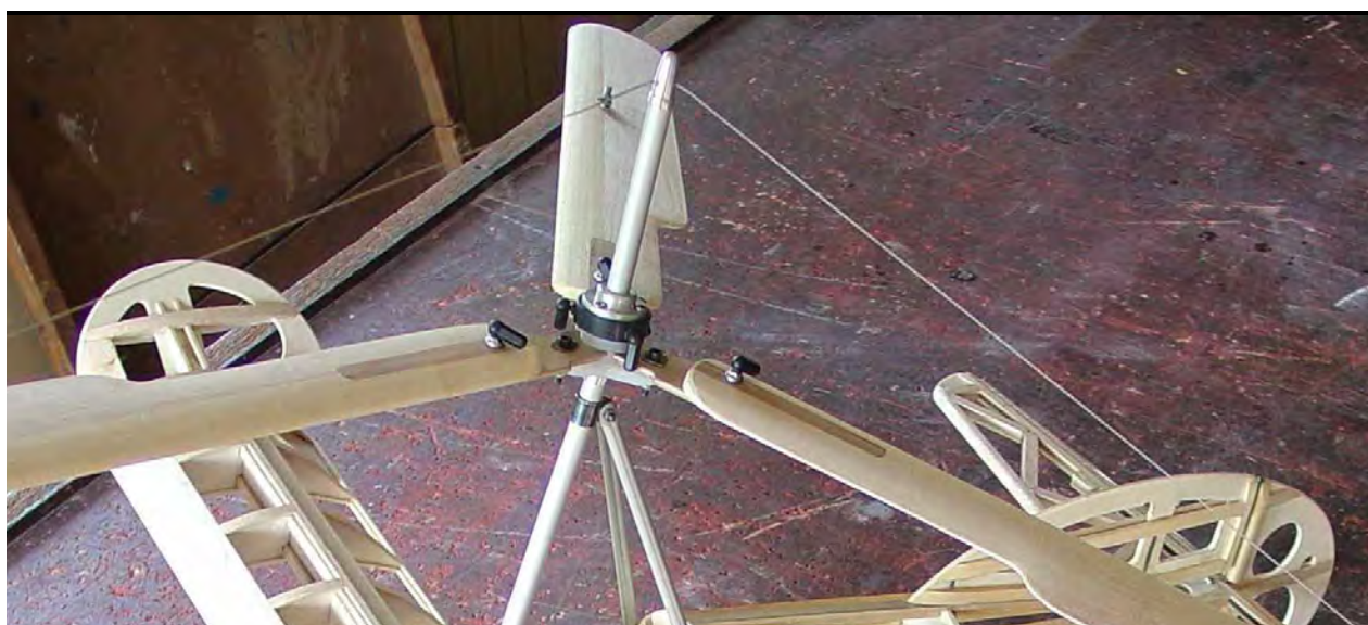
Pale in legno ancora da rivestire (di Marco Scarfò). Si nota il bordo d'attacco in obeche, l'inserto di noce alla radice e la pala in balsa.
