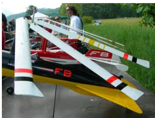
Pale in legno dell'autore rivestite con film termoretraibile
