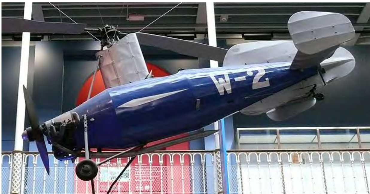
Il Weir W-2 del Museo di Edinburgo dotato di contrappesi sul bordo d'attacco delle pale, all'estremità. (Internet)
