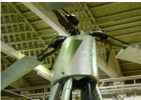
Ammortizzatori per Lead and Lag di un C.30 (cavi e pulegge)
