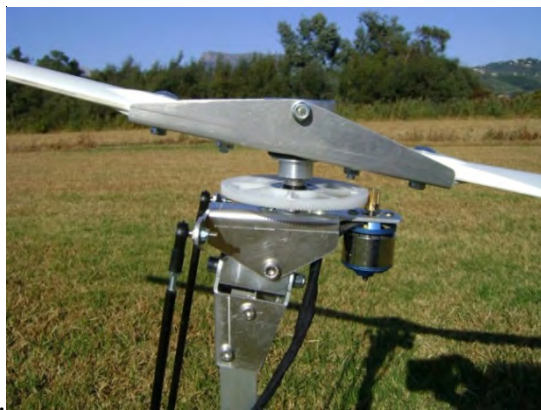
Pre-rotazione con motorino elettrico brushless verso poppa e verso prua (D'Alessandro)
