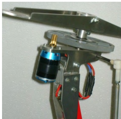
Pre-rotazione con motorino elettrico brushless verso poppa e verso prua (D'Alessandro)
