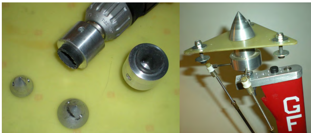
Organi del sistema di prerotazione con trapano a batteria esterno (autore/Gian Carlo Fava)
