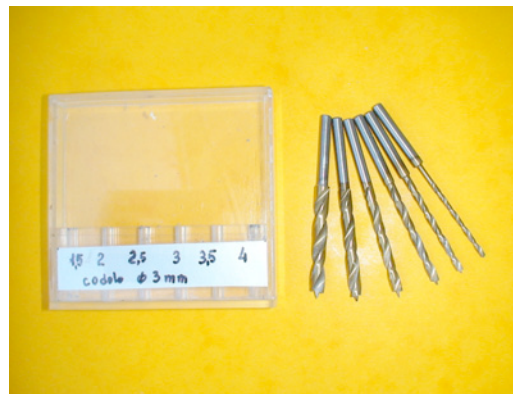
Foto n° 10 punte per trapano con codolo da 3 e punta a centrare di produzione Proxxon
