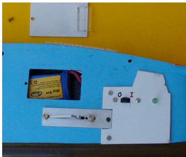
Fusoliera Paireli, scassi per cicalino ed interruttore (chiuso), batteria e stop timer
