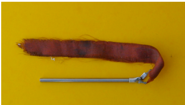
Foto n° 14 Spina per blocco ghiera porta utensili BFW40/E
