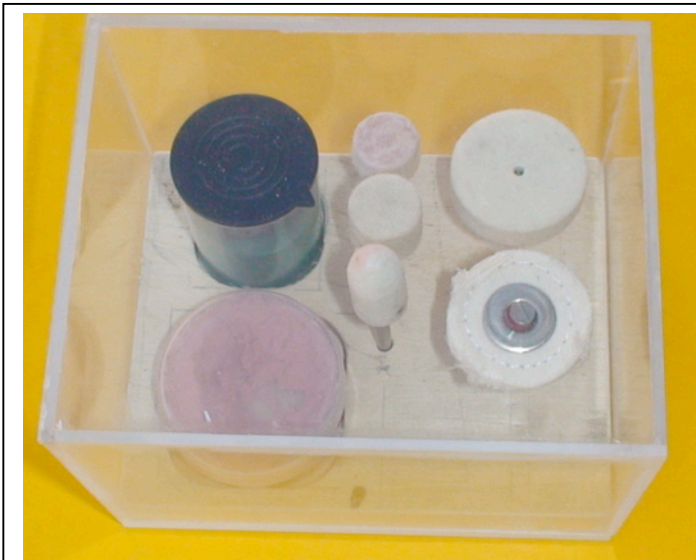
Foto n°13 dischi per rifinire, levigare e lucidare. Contenitore autocostruito con sedi per le paste lucidanti.
