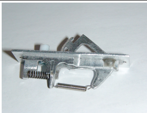
Stop timers meccanici originale (A. Roux), impiegato come modello per quelli in uso
