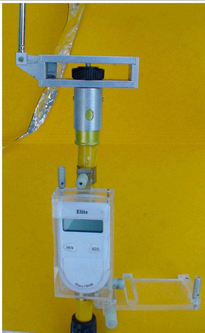
Asta per anemometro con cronometro a scalare, porta bussola e bandiera segnamento (asta porta bandiera ricavata da un'antenna per autoradio e pieghevole verso il basso)
