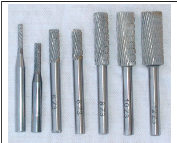
Foto n° 8 frese da 3 a 12 mm, da forniture industriali.
