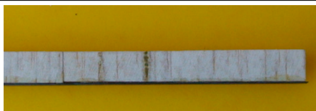
Particolare longherone in costruzione tagliato e portato a misura con la BFW40/e
