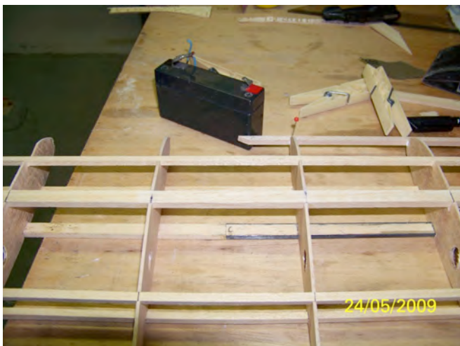
Figura 6 - I 2 listelli 10x5mm che costituiscono il longherone principale. In quello inferiore (tensore) ho aggiunto 2 listelli in fibra di carbonio, per scaricare le fibre del legno.
