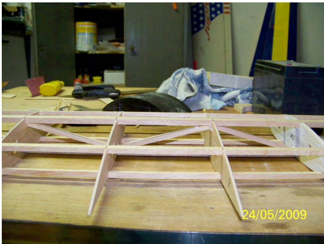
Figura 7 - Listelli inclinati a realizzare triangoli tra i listelli del longherone e tra le centine, con lo scopo di mantenere la distanza verticale.
