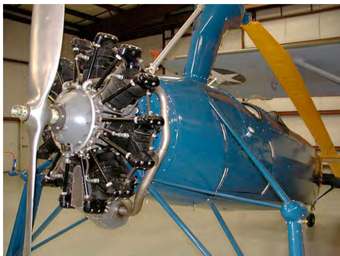
Il Kellet militare KD-1 diventato “YG-1A” secondo la denominazione ufficiale. Vistoso l’albero di prerotazione anteriore.
