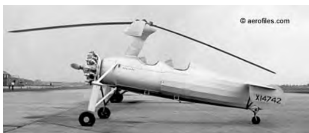
Il Kellet KD-1 biposto in tandem senza ali con rotore a controllo diretto. Le pale ebbero corda ridotta a 305 mm e profilo Gottinga 606.
