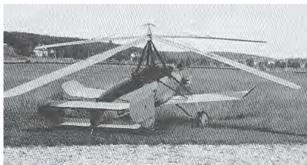
Il C.19 con impennaggio orizzontale biplano. Inclinandosi a cabrare di 75^\circ si formava un piano pressoché continuo che convogliava la scia dell'elica contro una parte delle pale che si mettevano a ruotare.
