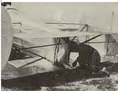
Come nel Cierva C.19 il PCA-1 A ebbe impennaggi biplani inclinabili a oltre 70° per mandare la scia dell'elica verso il rotore.
