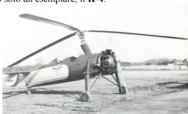
Il Kellet KD-1 biposto in tandem senza ali con rotore a controllo diretto. Le pale ebbero corda ridotta a 305 mm e profilo Gottinga 606.
