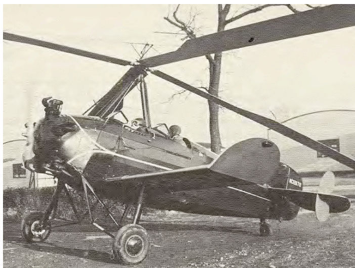
Il PA-18 fu leggermente più grande del PAA-1. Ne vennero costruiti 19 esemplari. La prerotazione veniva fatta con una presa di moto dal motore mediante albero e frizione che veniva disinnestata in decollo ad evitare la coppia del rotore.
