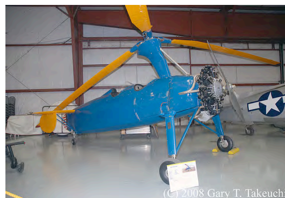
Il Kellet militare KD-1 diventato “YG-1A” secondo la denominazione ufficiale. Vistoso l’albero di prerotazione anteriore.
