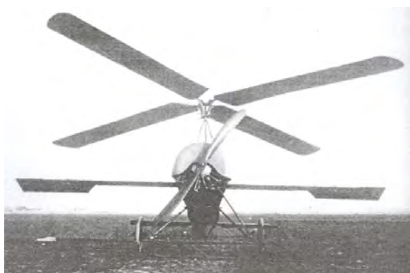
La versione finale del C.4 con alettoni. Da notare i controventi che impedivano un'eccessiva deformazione delle pale verso l'alto.
