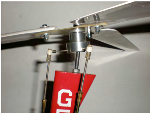
Controllo diretto – flappeggio con piastra flessibile (Bugada-Fava)
