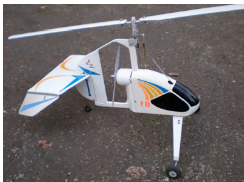
FB 11 di Franco Bugada bipala elettrico. Tutti i suoi modelli hanno rotore di 1,7 m di diametro e peso intorno a 2,5 kg.
