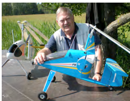
FB 11 di Franco Bugada bipala elettrico. Tutti i suoi modelli hanno rotore di 1,7 m di diametro e peso intorno a 2,5 kg.
