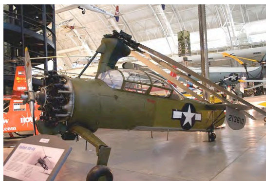
L’YO-60 fu sostanzialmente un YG-1B con motore potenziato.
