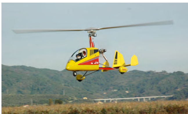
Sempre di Paolo il Gyrone dotato di motore a scoppio OS .70 4 tempi. 4 kg di peso con diametro rotore 1740 mm. E' disponibile in scatola di montaggio della Experimental Models di Viareggio, praticamente pronto al volo.
