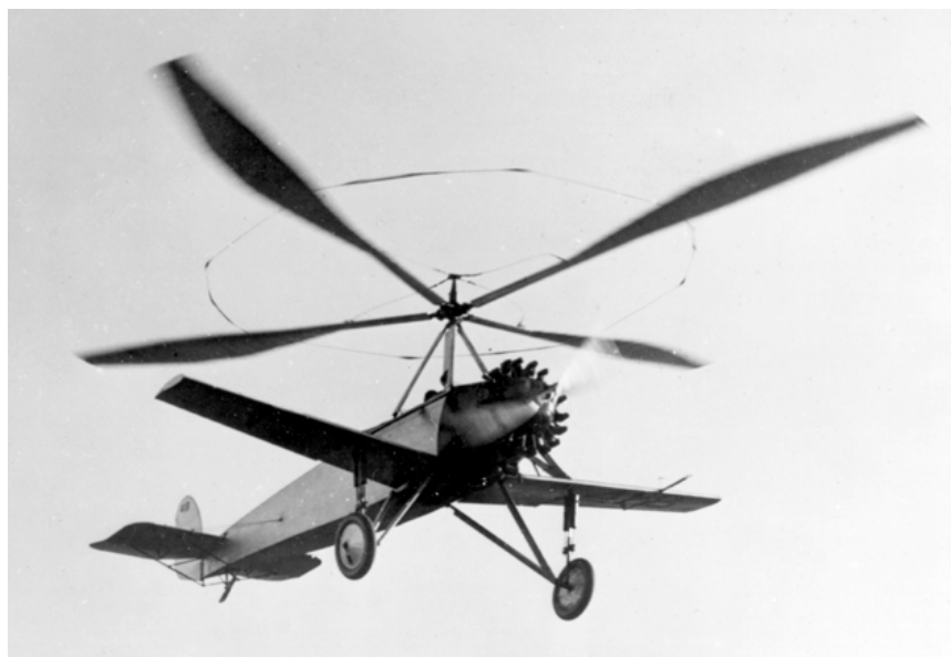
Il C.8 che venne ordinato da Pitcairn senza pattino di sicurezza anteriore e col 9 cilindri American Wright J-5. Si notano molto bene i cavi distanziatori delle pale che tracciano un cerchio e evidenziano i loro ammortizzatori- tenditori.
