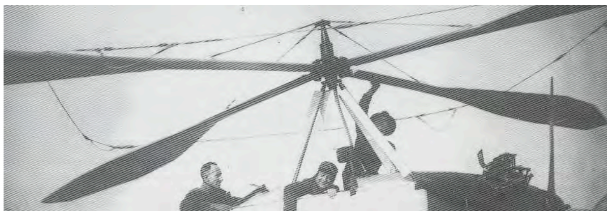
La ragnatela di cavi del rotore del C.8 L.III prevedeva 4 tiranti che partivano dalla sommità dell'albero rotore e 4 cavi distanziatori fra le pale, dotati di ammortizzatori e cavetto di sicurezza in caso di loro rottura. Il tutto ovviamente girava disegnando arabeschi contro il cielo e fabbricando resistenza aerodinamica. C'era flappeggio e brandeggio.
