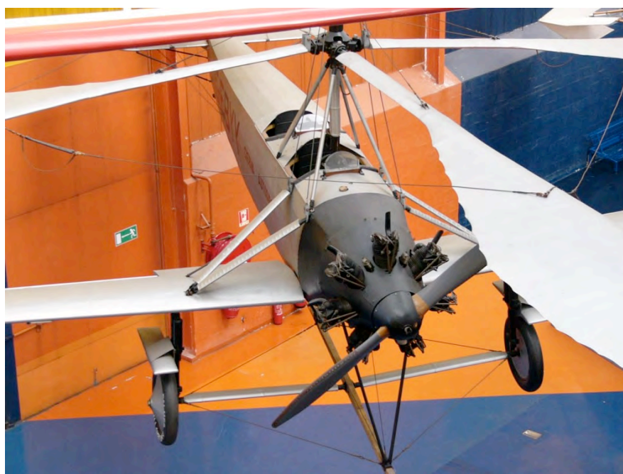
Il C.8 L. II con motore fisso Armstrong Siddeley da 200 Hp (immatricolato G-EBYY). Il rotore gira antiorario, l'elica oraria (vista dal davanti). Il rotore tende ad avere maggior portanza a destra (pala avanzante), la coppia di reazione del motore compensa questa tendenza.
