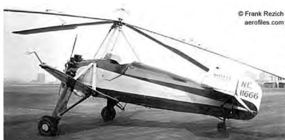
Il K-3 a due posti affiancati. Ben visibile l'albero con la presa di moto per la prerotazione.
