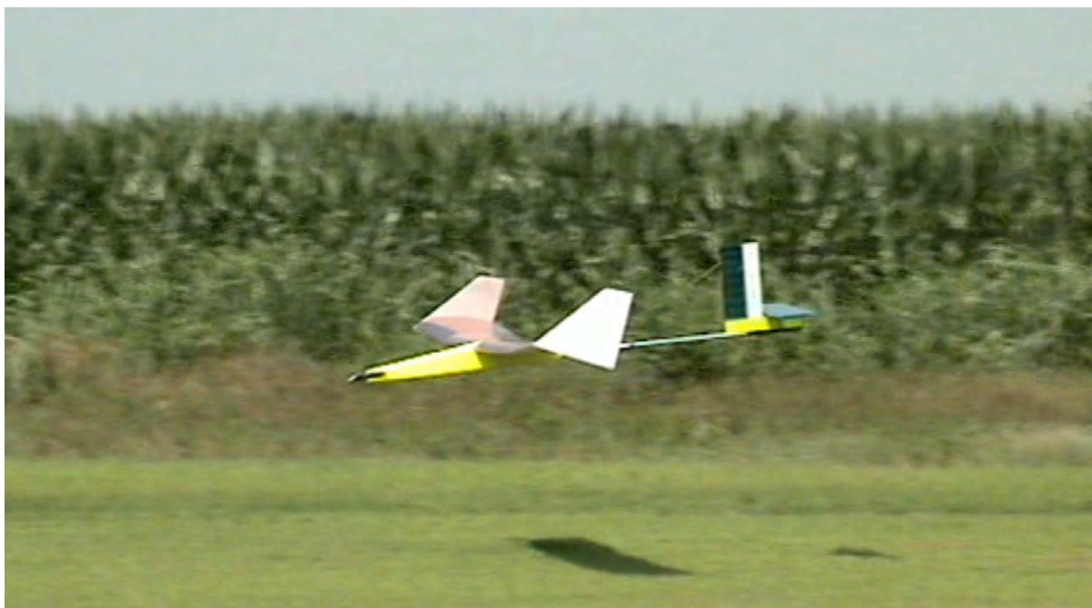
Fig. 7 - AP07 con Wing Let in atterraggio durante le prove di volo nella ricerca dei parametri ottimi.
