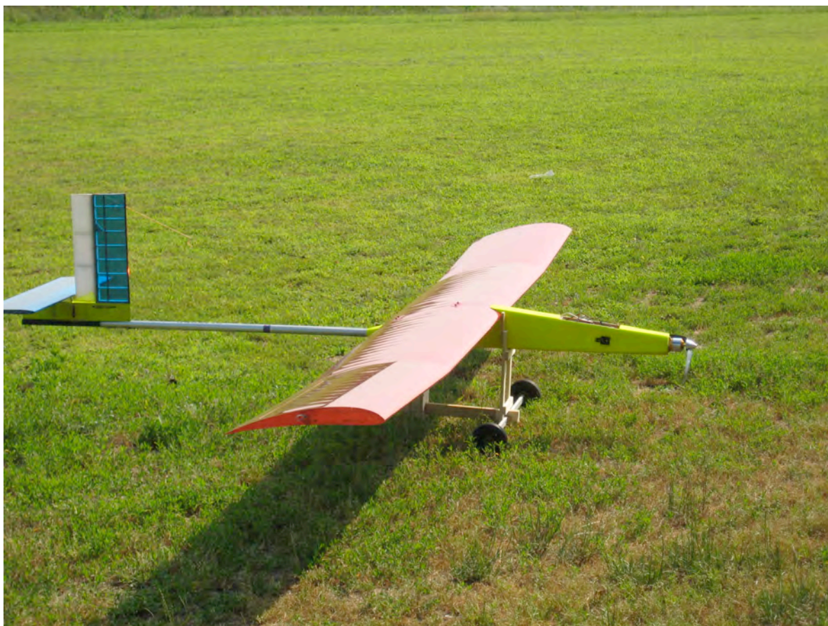
Fig. 6 - Aeromodello AP07 senza celle PV sulle ali
