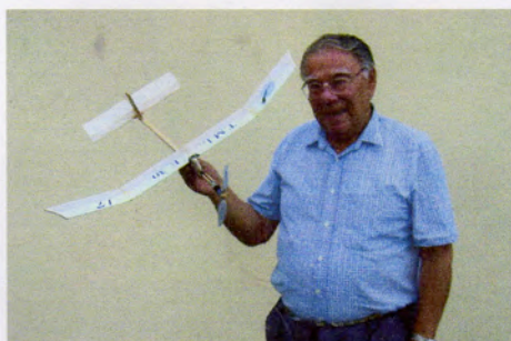
E 30 TML Apertura Alare 75 – Superficie 7-Peso 90 - Carico 13 – Motore LPS Rid. 6 – 1 –Batteria 4 x 5° mAh-Elica 8 x 4 – giri 3.900 Timer Pico –AT ,viscosita
