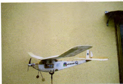
Atomizer Apertura Alare 114 – Superficie 17-Peso 300 –Carico 17 MOTORE 400 RACE 4,8 v –BATTERIA 5 X 110 MAH-ELICA 6 X 3 –GIRI 6.000
