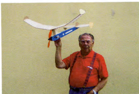
Strato-Streak - Apertura Alare 94 - Superficie 14 - Peso 300 - Carico Al. 21 Motore IPS 4,8 Volts - 4 celle 110 mAh - Rid. 7-1 - Elica 10 x 8 - Giri 4000
