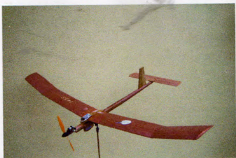
C.d.H Forte 2° Elettrico - Apertura Alare 129 - Superficie 15 - Peso 170- Carico 11 Motore IPS 7,2 V - Riduzione 5 - 1- Batteria 6 x 50 mAh - Elica 8 x 4 Giri 4.000
