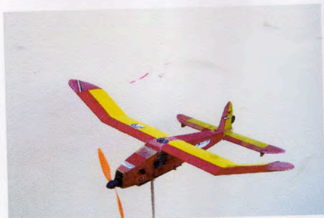
C.d.H Forte 2° Elettrico - Apertura Alare 129 - Superficie 15 - Peso 170- Carico 11 Motore IPS 7,2 V - Riduzione 5 - 1- Batteria 6 x 50 mAh - Elica 8 x 4 Giri 4.000
