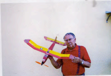
C.d.H Forte 2° Elettrico - Apertura Alare 129 - Superficie 15 - Peso 170- Carico 11 Motore IPS 7,2 V - Riduzione 5 - 1- Batteria 6 x 50 mAh - Elica 8 x 4 Giri 4.000
