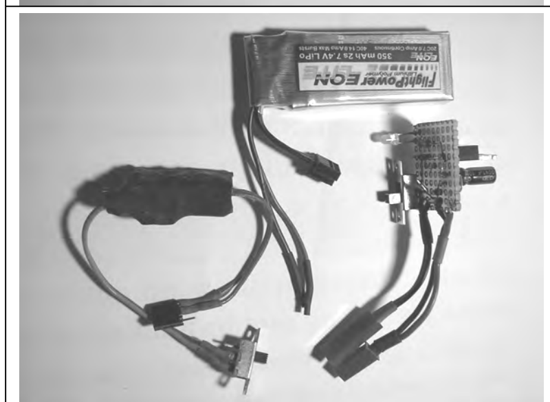
Abbattitori di tensione da 7,4 a 5 Volts autocostruiti
