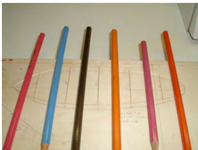
Incollaggio di un elica per F1D con il metodo delle matite
