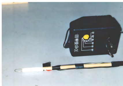
Foto: Il goniometro ed dispositivo a filo caldo per il taglio della ricopertura
