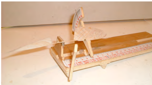
Foto: Il goniometro ed dispositivo a filo caldo per il taglio della ricopertura
