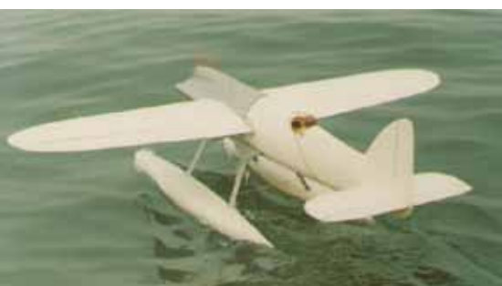
Tutto bianco; N.4 in Bleu, carenatura in lega leggera lucidata metallo; Union Flag on the rudder. AA. 9.3 mt, Lungh. 8,12, Superficie 12,91 mq, Carico al. 112,28 kg/mq, Napie Lion VII° da 680 hp.
